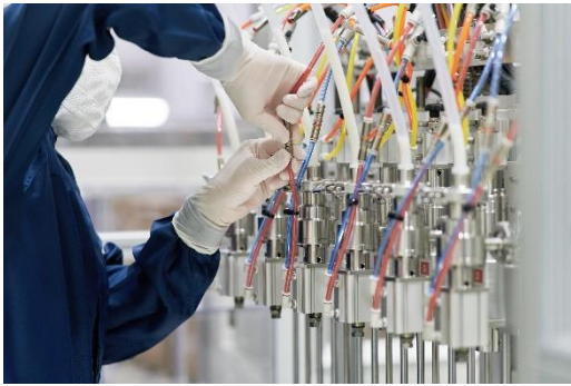
ドモホルンリンクルを容器へ充填する際に使用するボトリングライン（液剤充填機）
