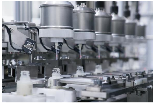
ドモホルンリンクルを容器へ充填する際に使用するボトリングライン（液剤充填機）
